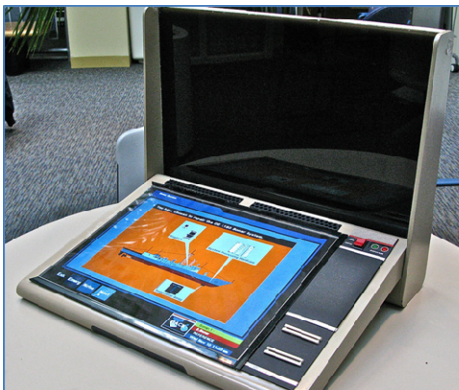
Рис. 6. Система EDS – концепция электронного руководства по техническому обслуживанию (1980 г.). Программное обеспечение фактически работало на специальном растровом дисплее VAX 11/780
